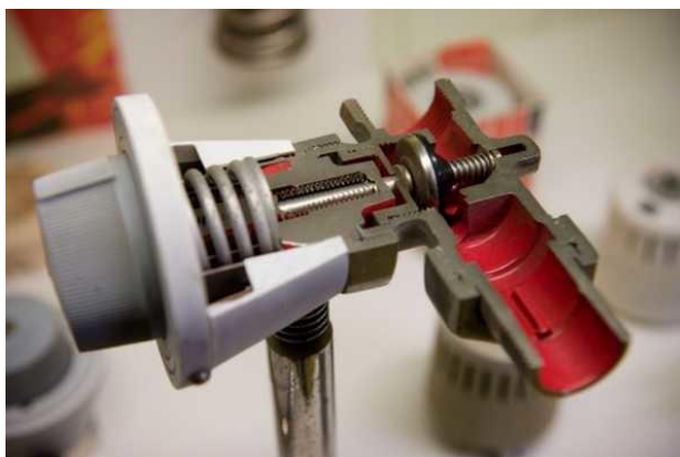
Так выглядит ручное устройство для регулировки температуры радиаторов в разрезе
